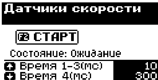
Рис. 18 Проверка датчиков скорости
