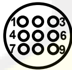
X1 Вид со стороны установки контактов (розетка)
