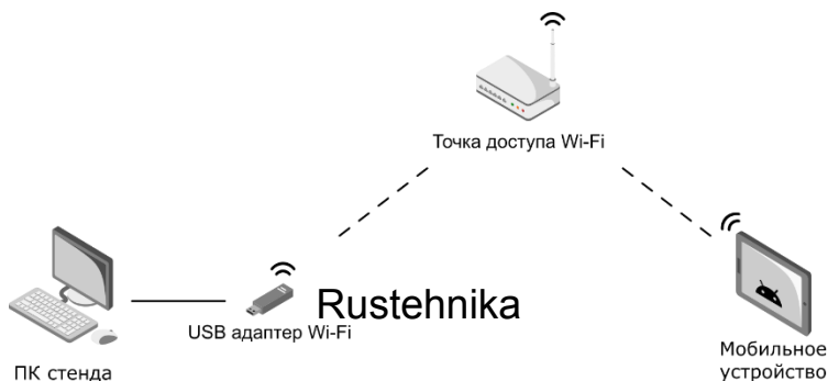
Рисунок 4.2 – Подключение ПК стенда и мобильного устройства к общей сети. Точка доступа настроена на внешнем устройстве
