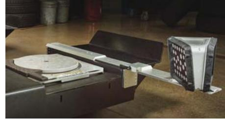
Элементы крепления адаптируются к обычным подъёмникам для регулировки и легко удаляются благодаря быстросъёмной системе.
