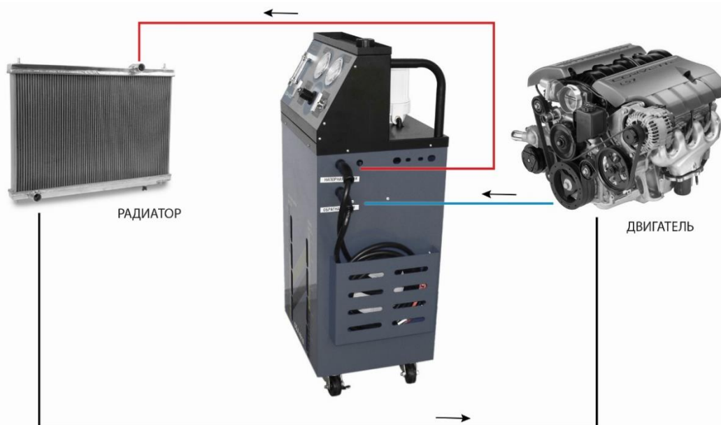
Рис. 3 Схема подключения изделия к системе охлаждения автомобиля
