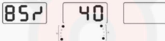
Медленно поворачивайте колесо до тех пор, пока не начнут мигать центральные индикаторы с обеих сторон; нанесите отметку на обод рядом с шиной в положение "на 12 часов".
