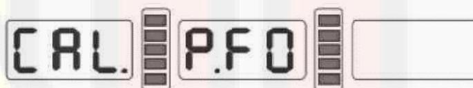
Передвиньте измерительное устройство в нерабочее положение (положение 0, устройство полностью выдвинуто) и нажмите кнопку ALU; на экранах отобразятся следующие символы
