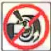
Данная табличка располагается возле балансирующего вала. Служит, чтобы напомнить пользователю, что данная часть – вращающаяся часть, и относится к опасным участкам, которую нельзя трогать руками. Стрелка показывает направление вращения.
