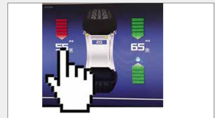
Функция Stop-in-Position Оператору нужно только коснуться указателя массы груза на экране, и колесо автоматически поворачивается в положение уравнивания.
