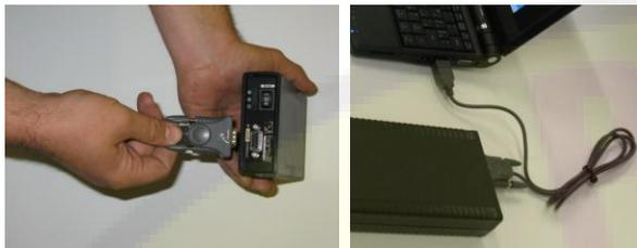
Соединение с USB-портом компьютера через адаптера USB-COM.
