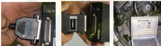
Для подключения к автомобилю предназначен 25-контактный разъем на торцевой стороне модуля BARS III. С помощью соответствующих кабелей и адаптеров модуль BARS III подключается к диагностическому разъему автомобиля. Питание модуля у большинства автомобилей осуществляется от диагностического разъема автомобиля.
