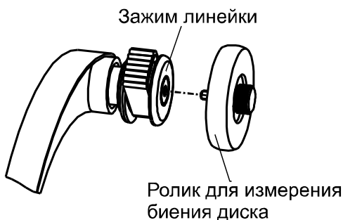
Рисунок 7.5 – Ролик для измерения биений
