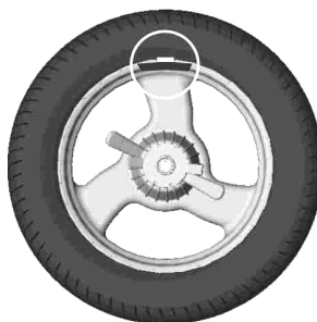
Рисунок 6.6 - Груз установлен в «12 часов»
