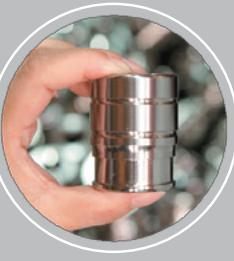
Придание внешнего диаметра головке и создание проточек
