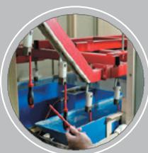
Тестирует диэлектрические инструменты под напряжением 1000 вольт
