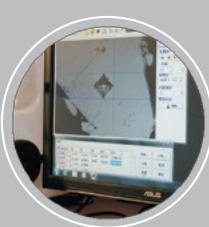
Анализирует изменения в металлографии после тепловой обработки и разницу в твёрдости между поверхностью и центром детали
