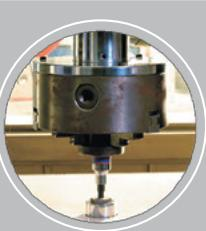
Тестирует продукцию с небольшим крутящим моментом, такую как вставки, на износостойкость
