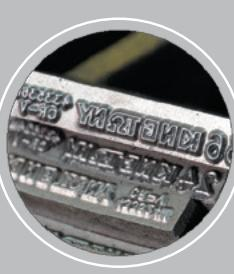
Штамповка размеров, материала и изготовителя
