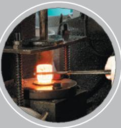
Нагревание для передачи формы и улучшения пластичности
