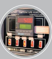
Создаёт резкий перепад температур от -20 до +70°C для анализа состояния детали с последующим выводами о ее качестве
