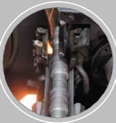
Удаляется оксидный слой и обеспечивается округлость головки для дальнейшего высокоточного процесса обработки
