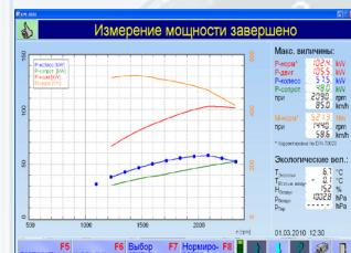
Определение маховых масс посредством повторного выбега, благодаря чему очень точно определяется эффективная мощность (патент MAXA)
