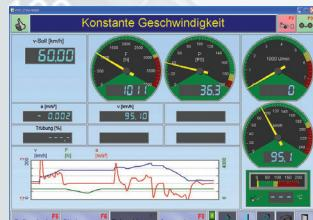
В режиме моделирования нагрузки пользователь может сам определить, какие величины будут отображаться в аналоговом, цифровом или графическом видах
