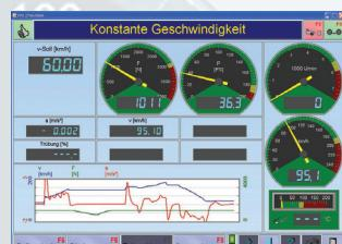
В режиме моделирования нагрузки пользователь может сам определить, какие величины будут отображаться в аналоговом, цифровом или графическом виде.
