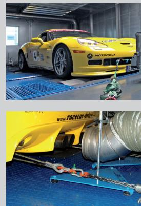
Полноприводный мощностной стенд в шумоизоляционной камере с системой вентиляции, включающей охлаждающий вентилятор и систему удаления ОГ для тюнинг-ателье Abt Sportsline GmbH (Германия)
