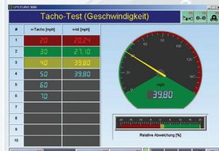
Проверка показаний автомобильного спидометра.
