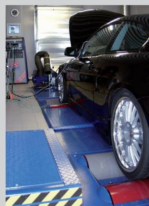
Полноприводный стенд в шумоизоляционной камере с системой вентиляции, включающей охлаждающий вентилятор и систему удаления ОГ для тюнинг-ателье Hamann GmbH (Германия)
