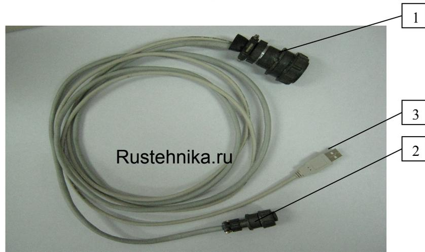
Кабель соединения компьютера с БНС и тахосчетчиком.
