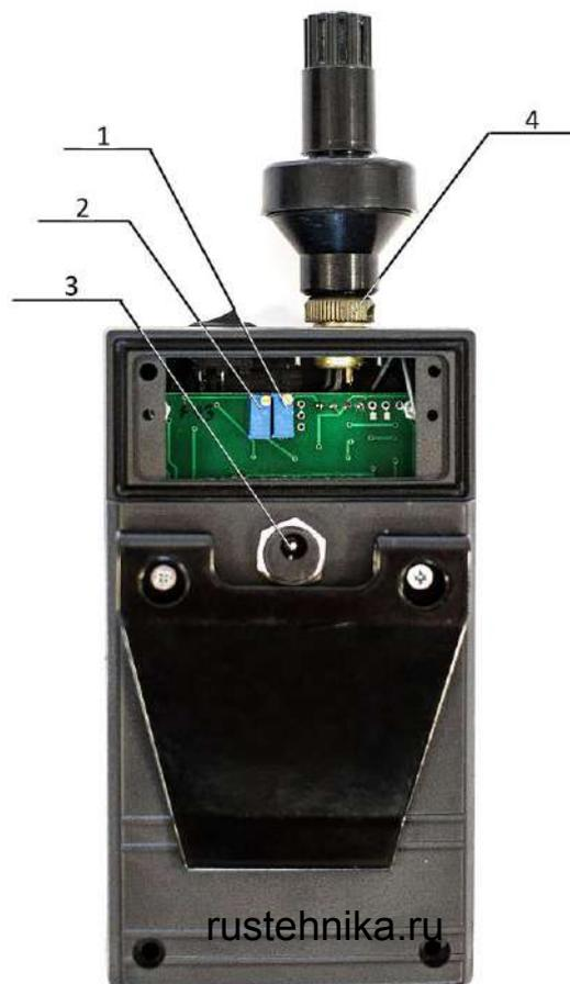
**Рис.3. Вид газоанализатора СИГНАЛ-4М сзади со снятой крышкой.**
