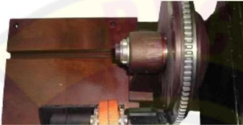
В ходе данного тестирования Вы можете проверить механическую целостность стартера, а так же приемы нагрузки.
