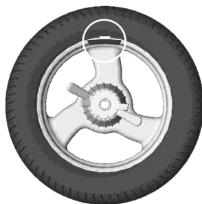
Рисунок 6.6 - Груз установлен в «12 часов»
