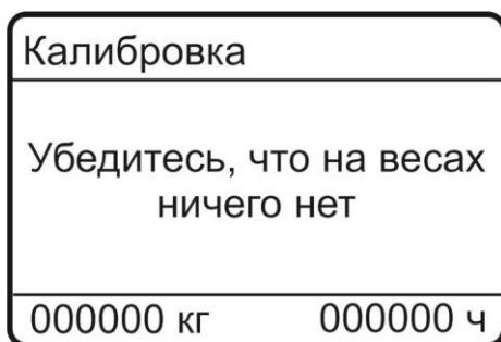
12.3.3.4. Установите на весы калибровочный груз весом 10 кг, нажмите «ПУСК».
