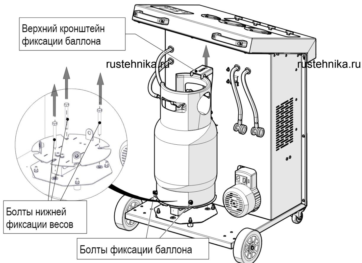
Рис. 5 Фиксация внутреннего бака
