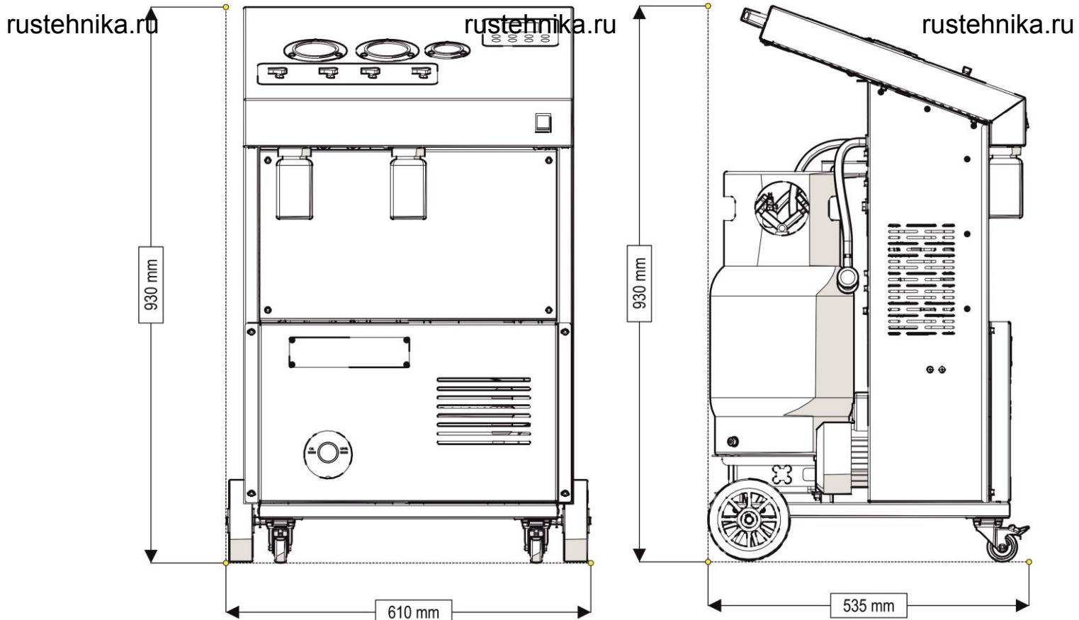
Рис. 1 Общий вид установки
