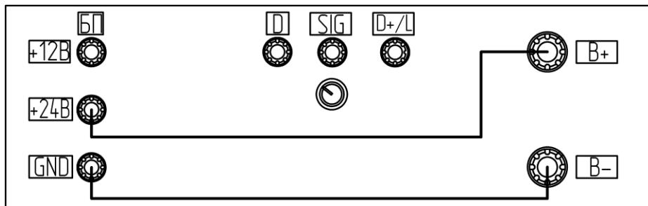
Рисунок 7 – Схема соединения клемм стендса при подзарядке встроенных аккумуляторных батарей
