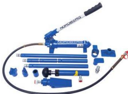
Рихтовочные элементы изготовлены из легированной, закаленной стали, методом отливки и последующейковки. Цилиндры, при снятии нагрузки, автоматически возвращаются в исходное положение.
