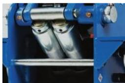
Двухштоковый механизм быстрого подъема
