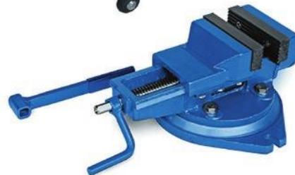
Изготовлены из высокопрочного чугуна, предназначены для неподвижной фиксации различных деталей и заготовок. Крепятся к столу или верстаку болтами. На тисках имеется наковальня. Основание тисков имеет поворотный механизм, благодаря которому корпус тисков можно разворачивать на 360°
