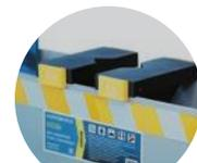
Фиксаторы предотвращающие соскальзывание рабочих насадок со станины
