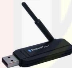
Если Вы используете внутреннее устройство Bluetooth-связи, то, скорее всего, все уже настроено на правильную работу. При использовании USB-Bluetooth-адаптера, возможно, потребуется установка драйверов для его правильной работы (системы Windows, начиная с XP, как правило, устанавливают такие устройства автоматически и не требуют установочного диска).
