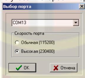
О выборе COM-порта подробно объяснено в разделе «Подключение к компьютеру». Скорость порта, как правило, следует выбирать высокую (230400). О том, в каких случаях указывается скорость 115200, также пояснено в разделе «Подключение к компьютеру». После внесения требуемых установок нажмите ОК.
