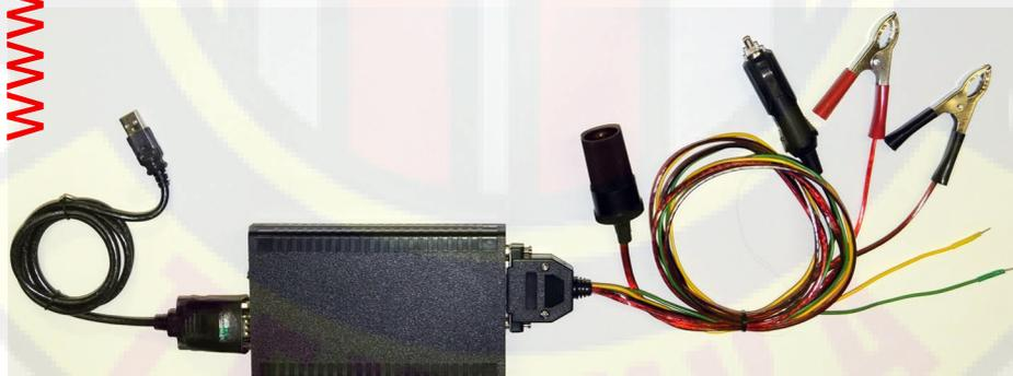
Используется универсальный кабель DB25. Питание сканера при использовании кабеля DB25 осуществляется через зажимы («крокодилы») непосредственно с АКБ автомобиля. Информация по подключению кабеля DB25 к диагностическому разъему автомобиля будет представлена диагностической программой после выбора соответствующего разъема. Также, эта информация содержится в таблицах 1 и 2.
