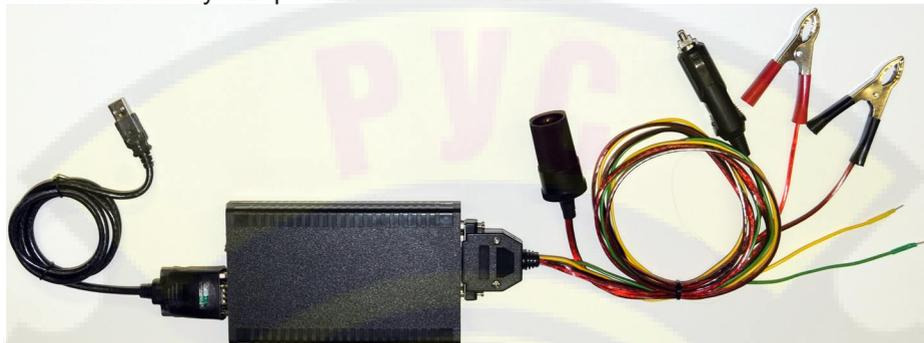
Кабель DB25 является базовым универсальным диагностическим кабелем. Он позволяет проводить диагностику при отсутствии диагностического кабеля BMW 20-pin.
