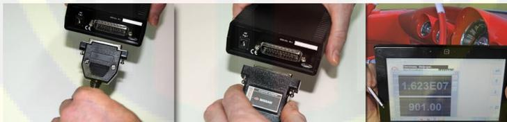
Для подключения к автомобилю предназначен 25-контактный разъем на торцевой стороне модуля BARS. Через этот разъем осуществляется обмен данными с электронными системами автомобиля, а также, в большинстве случаев, питание модуля (см. «Замечания по технике безопасности»). С помощью соответствующих кабелей и адаптеров модуль BARS подключается к диагностическому разъему автомобиля.
