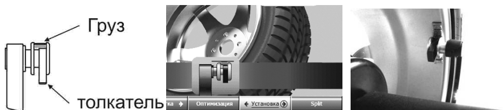
Рисунок 5.13 – Установка груза линейкой
