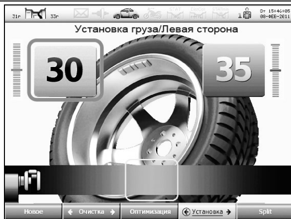
Рисунок 5.12 – Экран при установке груза линейкой
