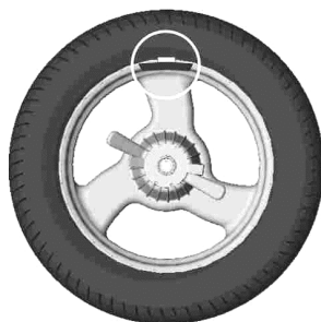
Рисунок 6.6 - Груз установлен в «12 часов»
