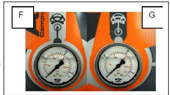
Рис. 10. Манометры масла.
