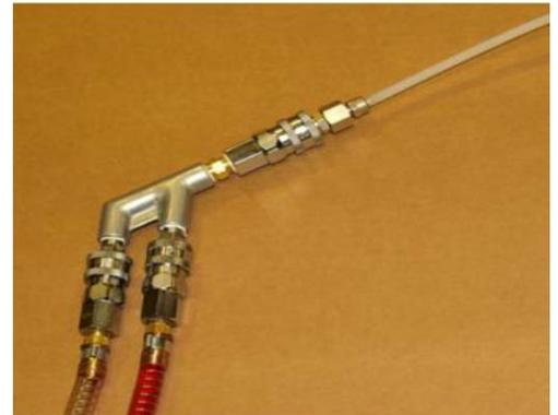
**Рис. 26.** Установка трёхходового фитинга.
