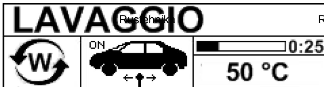
На экране отразится требование к пользователю запустить автомобиль и переставить (в автомобилях, где это возможно) кулисный рычаг таким образом, чтобы промывочная жидкость проникла во все части коробки передач.
