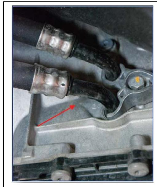
**Рис. 19.** Подсоединение станции к автомобилю.
