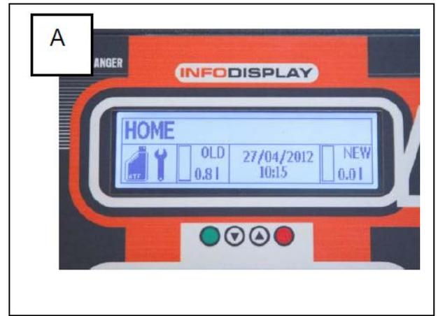
Рис. 9. ЖК-дисплей с разрешением 240x64.
