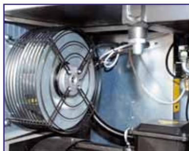
Система охлаждения оснащена электровентилятором с термодатчиком, что гарантирует оптимальную температуру в любых условиях эксплуатации.
