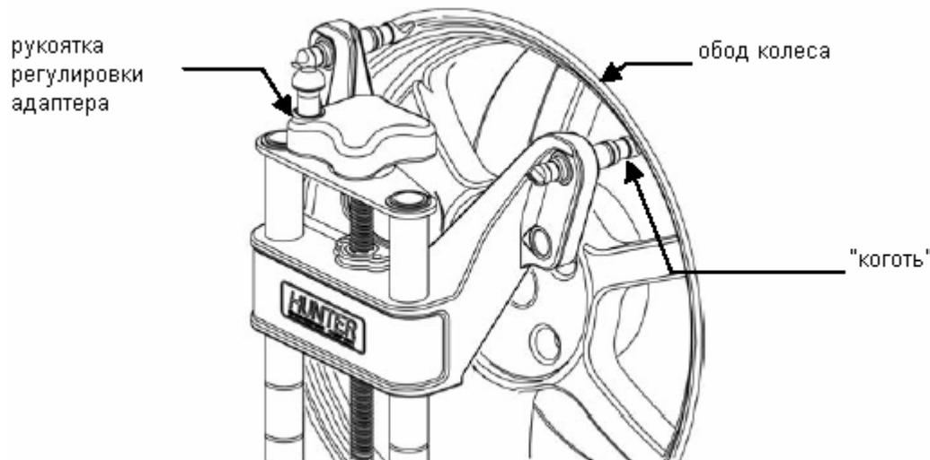
Слегка потяните за адаптер для проверки надежности закрепления адаптера на ободе.
