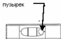
Для балансировки датчика ослабьте винты крепления груза к штанге датчика и сдвиньте груз в соответствующую сторону, чтобы сцентрировать пузырек внутри уровня.
