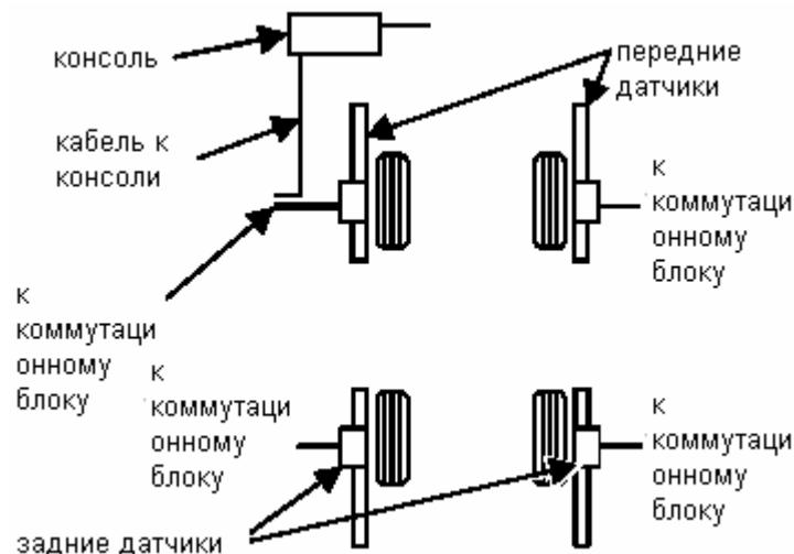
**Подключение кабелей при отсутствии на подъемнике дополнительного набора кабелей.**
