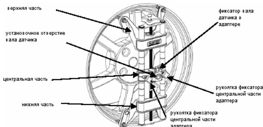
Если датчик не присоединен к адаптеру, присоедините датчик к адаптеру, вставив вал датчика в установочное отверстие на центральной части адаптера.
