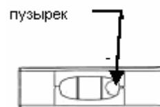
Для балансировки датчика ослабьте винты крепления груза к штанге датчика и сдвиньте груз в соответствующую сторону, чтобы сцентрировать пузырек внутри уровня.
