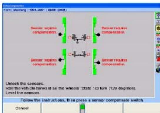
Выставьте датчики по уровню и зафиксируйте их. Зеленый светодиод на каждом датчике должен гореть.
