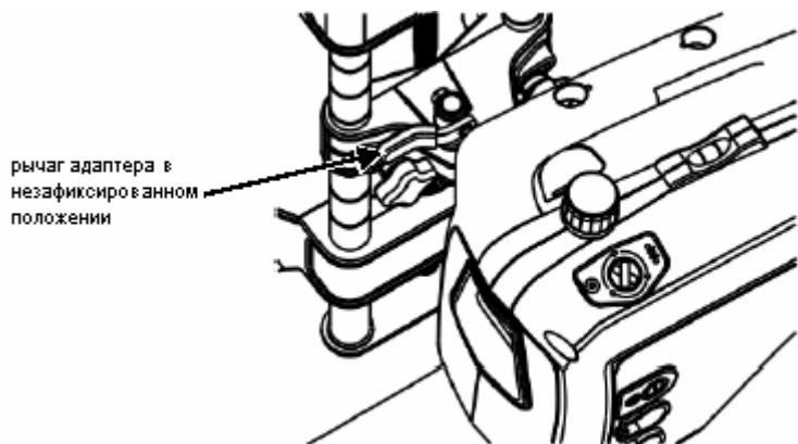
Поверните рычаг адаптера по часовой стрелке в положение «зафиксировано».
