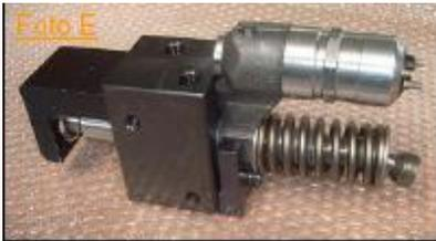
2. установить САМ-ВОХ на стенд, установить форсунку присоединить подачу и слив топлива, зафиксировать электропровода, залить смазочное масло, до уровня(стеклянный глазок)
