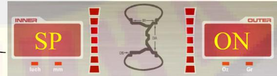
Нажимайте кнопки для настройки включения и выключения защитной крышки.
