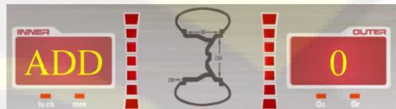
На дисплее отобразится "ADD"- "100". Руками проверните колесо и, когда все индикаторы на правом дисплее позиционирования загорятся, установите калибровочный груз массой 100 г в положении «12 часов» на внешнюю сторону диска. Устанавливайте груз именно в этом положении. В противном случае точность балансировки будет значительно ниже. Запустите станок еще раз и произведите
