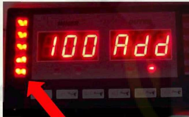
Рукой вращайте колесо до тех пор, пока на левом позиционном дисплее не зажгутся все индикаторы. Установите калибровочный груз  $100 \pm 0.5$  грамм на внутреннюю сторону колеса в положении «12 часов».
