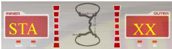
В режиме **DYN** нажмите на пьезоэлектрический датчик перпендикулярно по отношению к балансировочному валу. Значение в правом поле изменится. Это означает, что настройка датчика произведена правильно.
