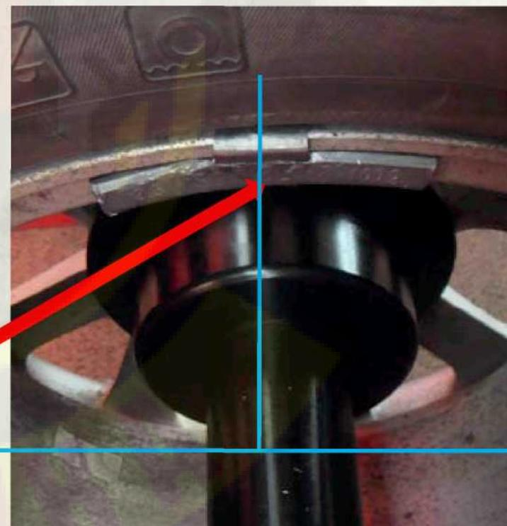
Рукой вращайте колесо до тех пор, пока на левом позиционном дисплее не зажгутся все индикаторы. Установите калибровочный груз  $100 \pm 0.5$  грамм на внутреннюю сторону колеса в положении «12 часов».
