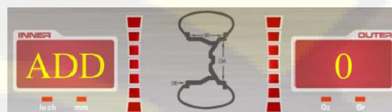
На дисплее отобразится "ADD"-100". Руками проверните колесо и, когда все индикаторы на правом дисплее позиционирования загорятся, установите калибровочный груз массой 100 г в положении «12 часов» на внешнюю сторону диска. Устанавливайте груз именно в этом положении. В противном случае точность балансировки будет значительно ниже. Запустите станок еще раз и произведите
