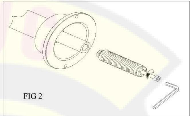
Монтаж балансировочного вала: Перед установкой используйте подходящий растворитель (например, этиловый спирт) и сжатый воздух для очистки центрального отверстия вала и соединительной части. Используйте торцовый ключ и винт для фиксации резьбового хвостовика на балансировочном валу (Рис. 2).
