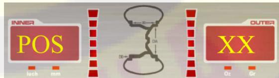
В режиме STA нажмите на пьезоэлектрический датчик перпендикулярно по отношению к балансировочному валу. Значение в правом поле изменится. Это означает, что настройка датчика произведена правильно.
