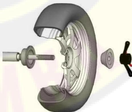
Балансировочный вал → колесо (внешняя сторона колеса устанавливается наружу) → конус → гайка.
