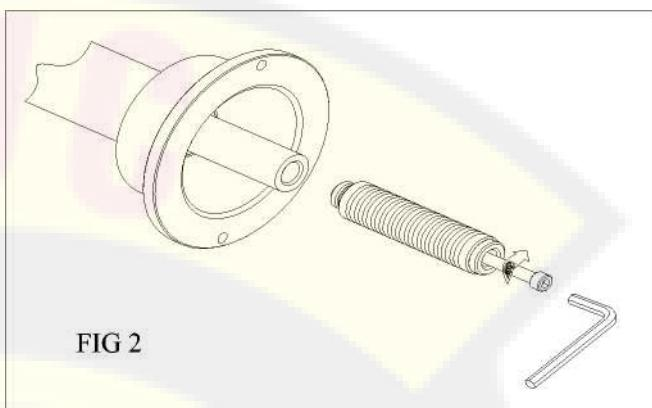
Монтаж балансировочного вала: Перед установкой используйте подходящий растворитель (например, этиловый спирт) и сжатый воздух для очистки центрального отверстия вала и соединительной части. Используйте торцовый ключ и винт для фиксации резьбового хвостовика на балансировочном валу (Рис. 2).
