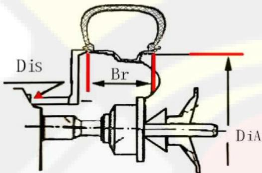
4. Опустите защитную крышку (можете также нажать кнопку пуска "Start"). После запуска, вращения и тестирования станок автоматически останавливается. В левом и правом полях отобразятся соответствующие значения. Произведите вращение колеса.
