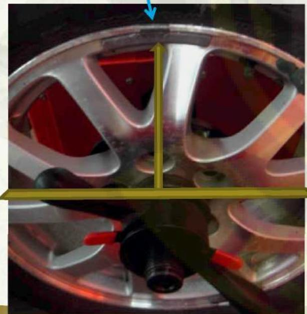
Рукой вращайте колесо так, чтобы на правом позиционном дисплее загорелись все индикаторы, установите калибровочный груз  $100 \pm 0.5$  г на внешнюю сторону колеса в положении «12 часов».
