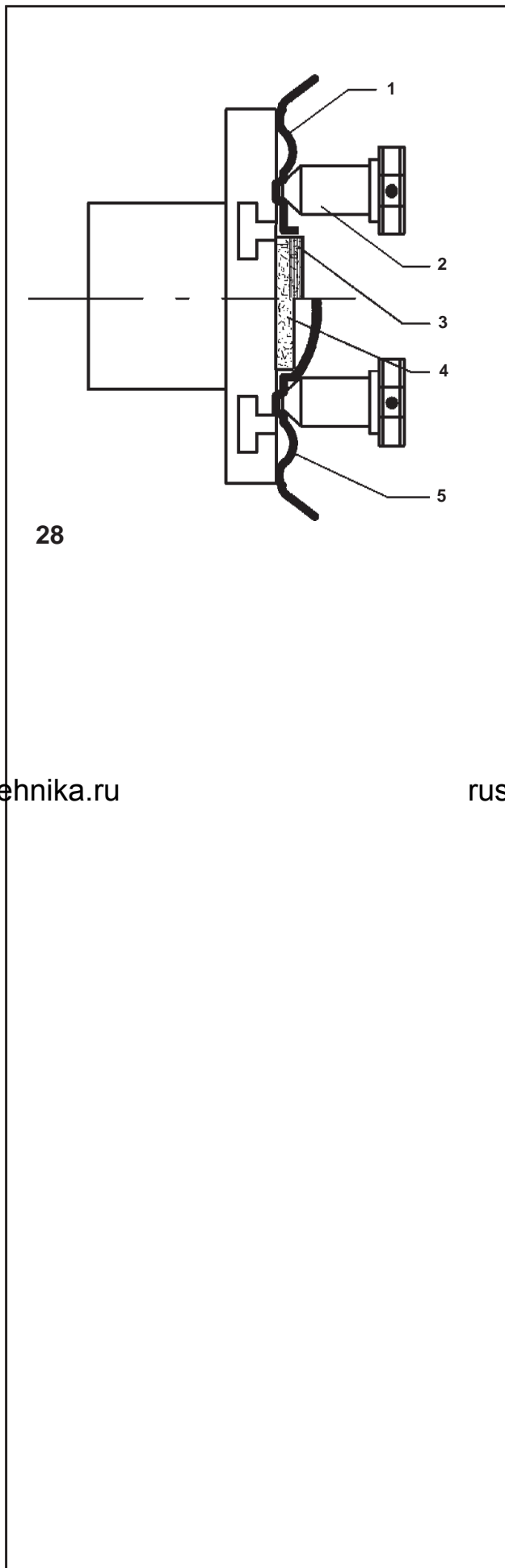
Рис. 28 Универсальный адаптер устройство для крепления колёс с закрытым диском или отверстиями под установочные штифты. Этот адаптер также подходит для крепления колёс с центральным отверстием при использовании подходящих центрирующих колец (дополнительные принадлежности).
