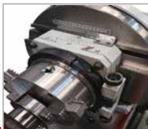
Индикатор горизонтального перемещения
