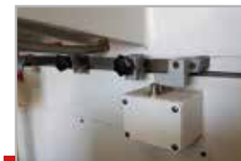
Концевые выключатели перемещения вперед, назад (ось Y)
