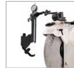
02119 Приспособление для непрерывного измерения (опция)
