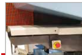
Боковая кнопка аварийного останова (доп. оборудование)
