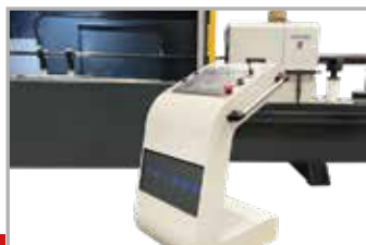
Передвижной контроллер с сенсорной панелью управления
