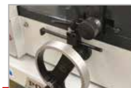
Электронный концевой выключатель стола
