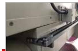
Концевые выключатели перемещения вперед, назад (ось Y)
