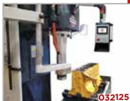
Вакуумная система для удаления пыли и стружки в процессе расточки (доп. оборудование)
