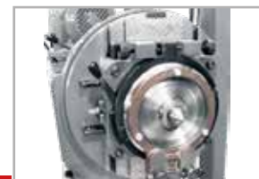
Центральное соединение на шпиндельной головке
