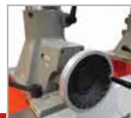
Приспособление для перемещения вниз-вверх и фиксации
