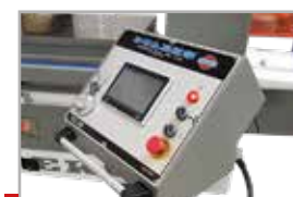
Контроллер с сенсорным дисплеем
