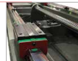
Линейные направляющие стола
