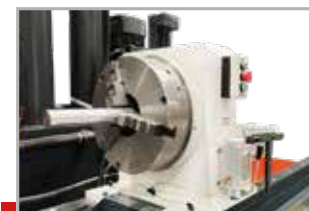
Автоматическая система зажима деталей поворотного типа (опция)
