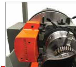
Фиксирующие винты для горизонтальных и вертикальных перемещений
