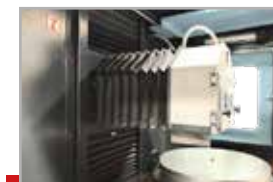
Гофрированные защитные кожухи направляющих
