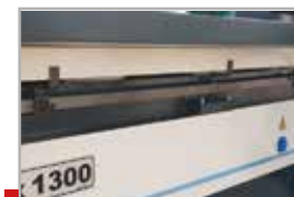
Концевые выключатели стола (ось X)
