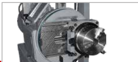
Эксцентрические перемещения шпиндельной головки при правостороннем и левостороннем положении патрона шпинделя
