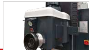
Микрометр системы центрирования
