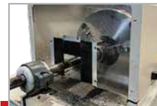
Зажимной патрон для обрабатываемой детали
