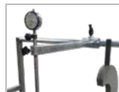
Держатель индикатора (доп. оборудование)
