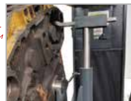
Пара приспособлений для быстрой наладки помогает быстро и надежно разместить блок цилиндров на рабочем столе станка
