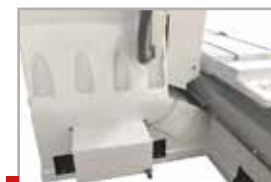
Бак для хранения слитого обработанного масла
