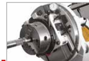
Место для держателя измерительного инструмента для контроля хода
