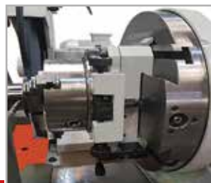
Штифты перемещения по направлению и фиксирующие винты
