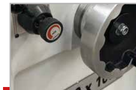
Рычаг регулировки скорости гидравлического привода перемещения стола (ось X)
