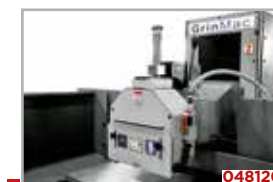
Устройство для правки шлифовальных кругов
