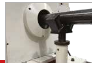
Регулируемая по высоте опора устройства зажима обрабатываемой детали
