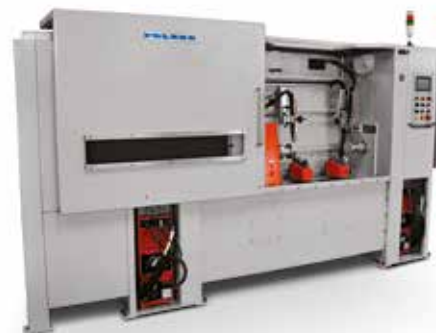
Автоматический станок для сварки цилиндров
