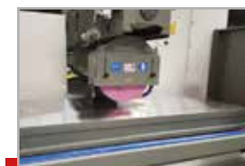
Электромагнитный стол (доп. оборудование)
