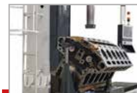
Лестница для обслуживания на колонне (ось Z)
