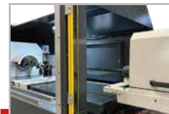
Инфракрасные датчики безопасности
