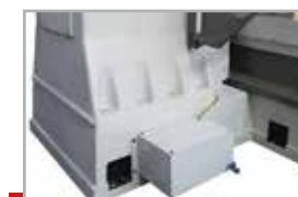
Бак для хранения слитого отработанного масла
