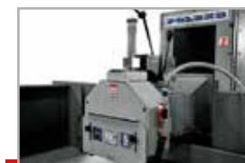
Устройство для правки шлифовальных кругов
